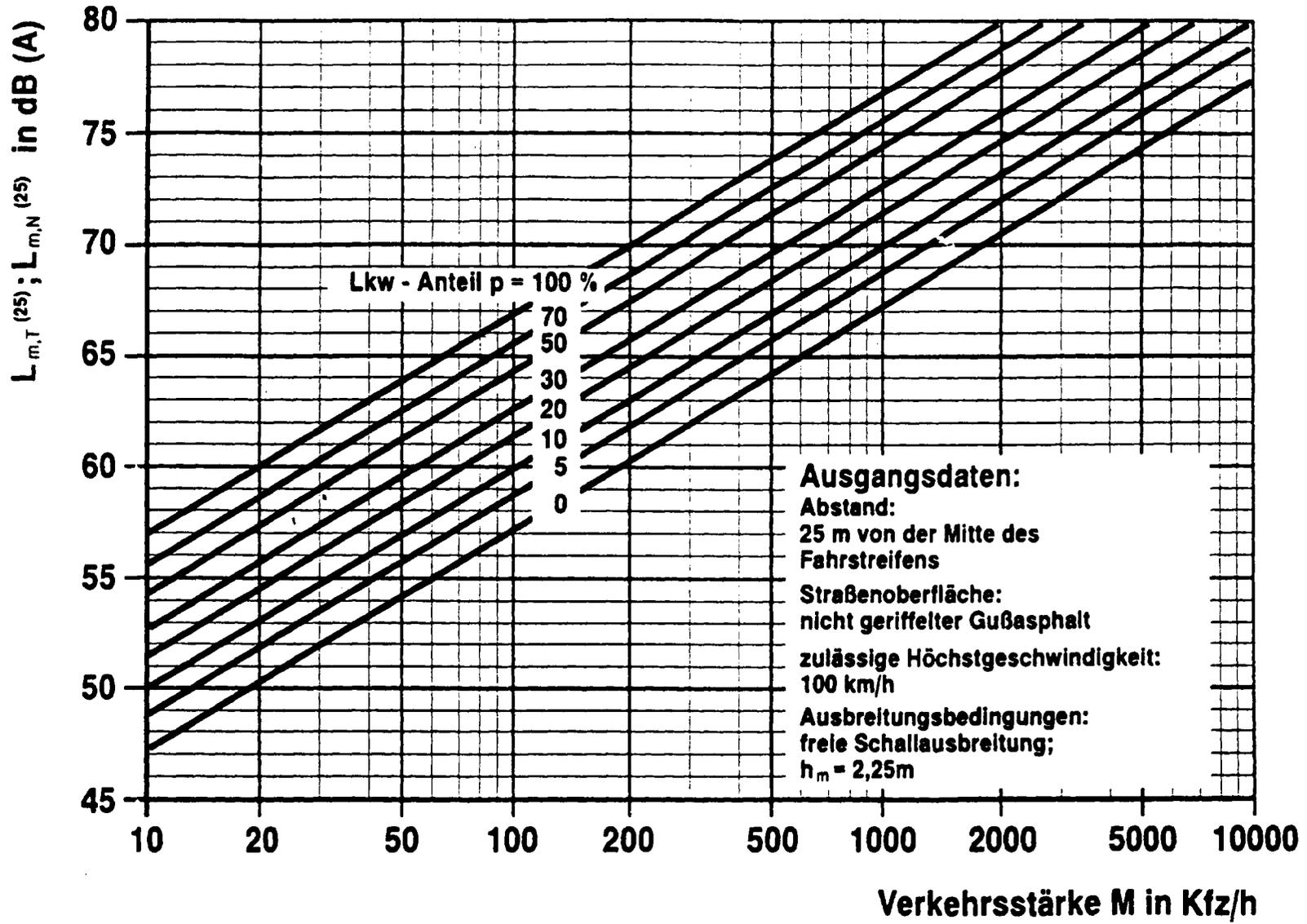
$$L_{m,T}^{(25)} \text{ bzw. } L_{m,N}^{(25)} = 37,3 + 10 \cdot \lg [M (1 + 0,082 \cdot p)] \text{ dB (A)}$$
