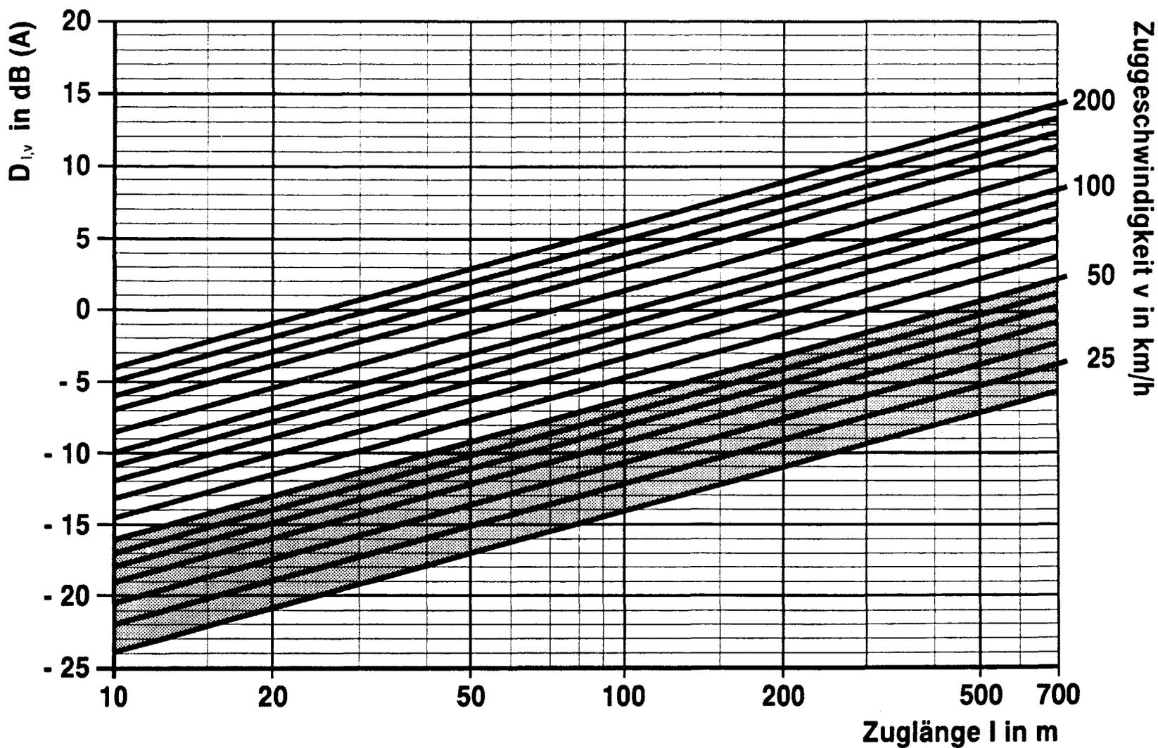
Der grau unterlegte Teil des Diagramms ist nicht für Züge des Fernverkehrs anzuwenden, dessen niedrigste Geschwindigkeit mit 50 km/h eingesetzt wird.
