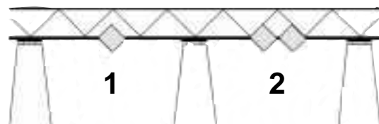
Brückendurchfahrt: 1 in beiden Richtungen 2 in dieser Richtung befahrbar, Gegenrichtung gesperrt
