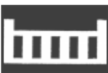
Hinweis auf ein Wehr
